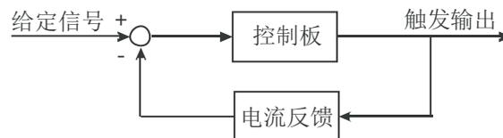
8.3、调机控制方式：即为开环控制模式，控制板的微处理器将输入信号经过线性化后直接变换成可控硅导通角触发输出，在这种调节方式下电源电压或功率变化时控制板输出也随着变化，具有过压和过流保护功能。示意图如下：
