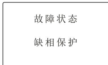
当出现故障时，故障继电器输出信号动作，运行继电器、负载输出断开，液晶屏右下方文字显示为故障，如需查询故障按 **FN**
