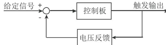
8.2、闭环恒流方式：在负载电压小于电压限制参数时，控制板的微处理器将电流反馈信号和给定信号比较，当电流反馈信号小于给定信号时，微处理器将增加输出直到电流反馈信号与给定信号相等，当电流反馈信号大于给定信号时，微处理器将减小输出直到电流反馈信号与给定信号相等。这种调节方式只要输入信号不变，即使电源电压变化或负载阻抗发生变化负载电流始终维持不变（不包括电网和负载阻抗瞬间突变），具有电压限制功能，电压限制具有优先权。示意图如下：
